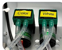
| Bombas de Tinta
